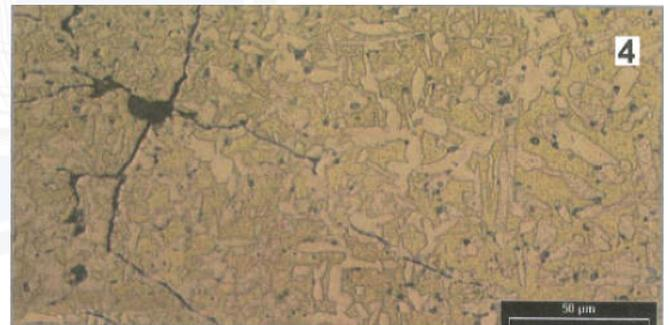
4 TW-Kupplung China: Risse und Poren nahe der Oberfläche
