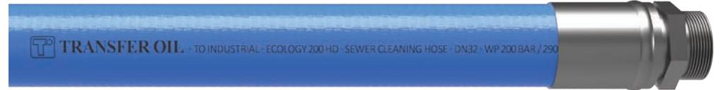
Dieser Hochdruckschlauch findet seine Verwendung in der Kanal- und Rohrreinigung. Der Ecology 200 weist gegenüber herkömmlichen Gummi-Kanalspüschläuchen eine Gewichtsersparnis von bis zu 30% auf. Das thermoplastische Polymer zeichnet sich durch exzellente Abriebwerte und Schnittfestigkeit aus und besitzt somit eine hohe Langlebigkeit. Die blaue Schlauchdecke ist zudem beständig gegenüber mikrobiologischen Angriffen.
