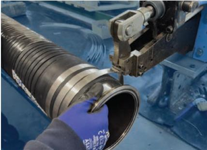
Die für mich passenden Armaturen werden mit den dazugehörigen Schellen befestigt, welche mit all meinen zur Identifikation relevanten Daten versehen sind. Dies geschieht mit einer Prägemaschine.
